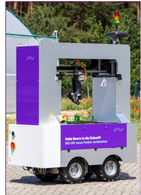
Abbildung: Pflückroboter zur Erdbeerernte (Quelle iav)
